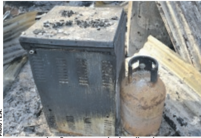
Les flammes seraient parties de cette gazinière calcinée.
