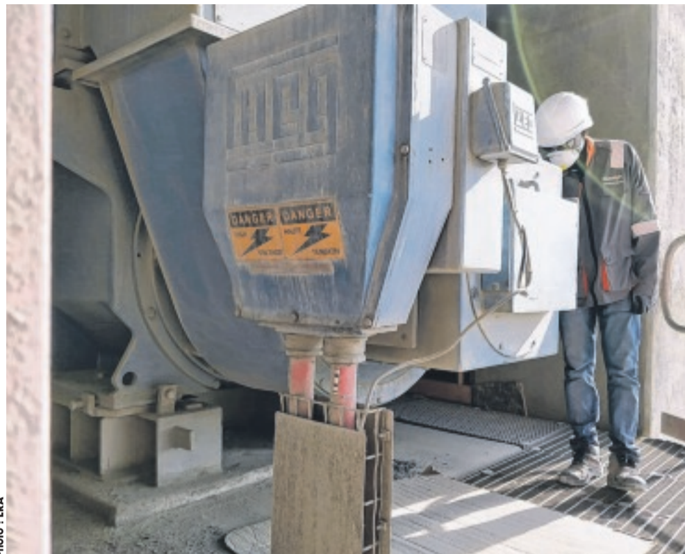
L'instrumentiste, ici, contrôle la température et la pression sur le moteur du broyeur...
