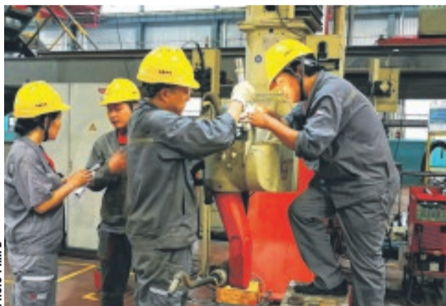
Des ingénieurs assurant la maintenance d'un robot de soudure automatique dans un atelier de CRRC Ziyang.
