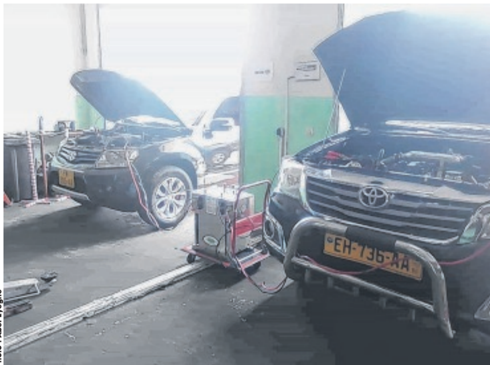
Le décalamineur branché sur deux véhicules, pour le nettoyage du moteur.
