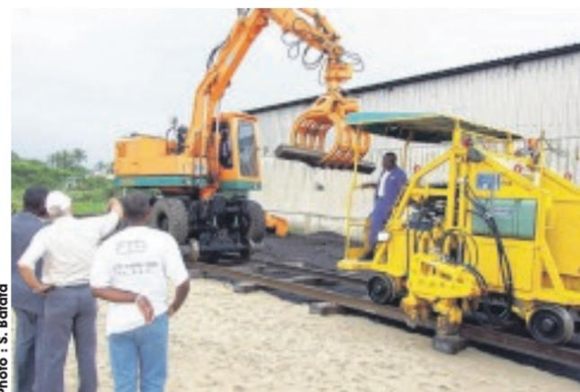
Une machine servant à remplacer et à recalibrer des traverses.
