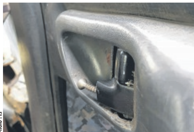
Des poignées d'ouverture de portières remplacées par des pointes à vis.
